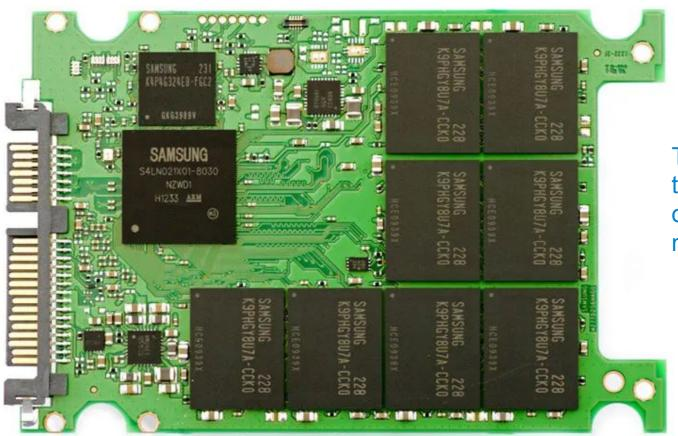
Todo em transistores, sem operação mecânica.
